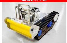
豪雪地帯での雪おろし時の滑落事故を防ぐ、 「遠隔操作で安全に屋根の雪を滑り落とす ことができる雪おろし機」
